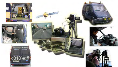
Рисунок 1.8 – Мобільна дорожня лабораторія «МУДРЕЦ» (основне обладнання)
